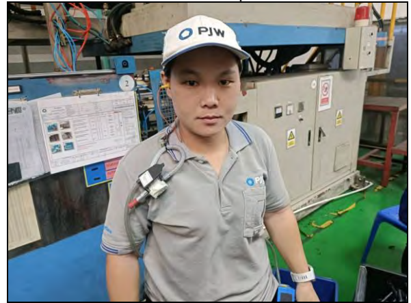
ภาพที่ 26 การเก็บตัวอย่างฝุ่นละอองขนาดเล็กกว่า 10 ไมครอน บริเวณ อาคาร B - หน้าเครื่อง BE006 (คุณทินกร นามเกียรติ)
