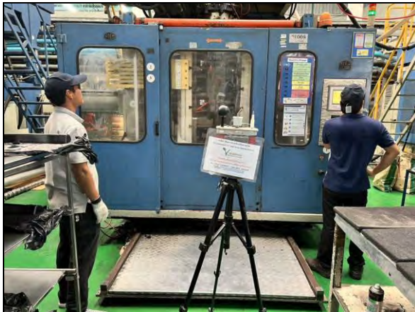
ภาพที่ 77 การตรวจวัดระดับความร้อน บริเวณ อาคาร B (BI009)
