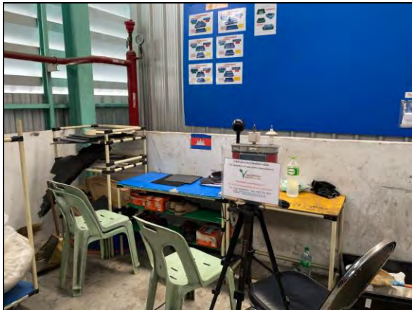
ภาพที่ 83 การตรวจวัดระดับความร้อน บริเวณ จุด Box Control โรง E
