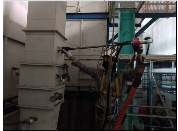
ภาพที่ 8 การเก็บตัวอย่างอากาศจากปล่องระบายอากาศ Exhaust Fan Mixing No.4 (Plant C)
