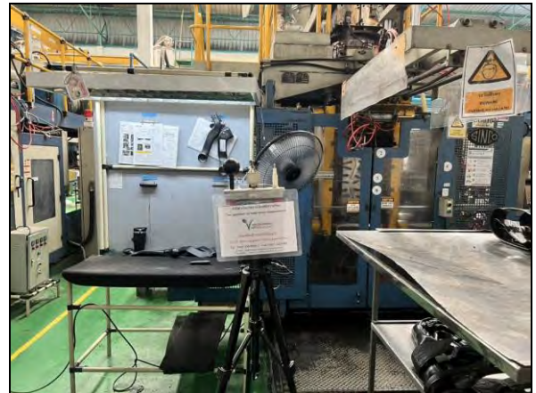
ภาพที่ 78 การตรวจวัดระดับความร้อน บริเวณ อาคาร B (BG010)
