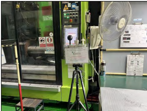
ภาพที่ 75 การตรวจวัดระดับความร้อน บริเวณ อาคาร C (IF018)
