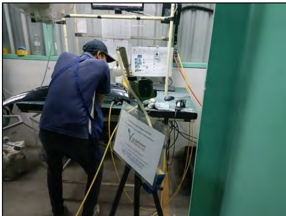
ภาพที่ 45 การเก็บตัวอย่างฝุ่นละอองรวม บริเวณ อาคาร E - Polishing (ชั้น 3)
