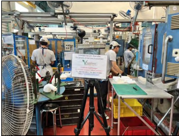
ภาพที่ 73 การตรวจวัดระดับความร้อน บริเวณ อาคาร A (BE005)
