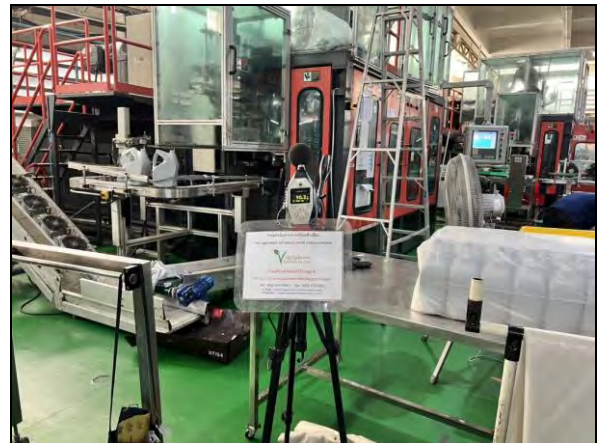
ภาพที่ 52 การตรวจวัดระดับความดังเสียงเฉลี่ย 8 ชั่วโมง บริเวณ อาคาร D (BS045)
