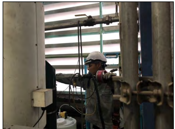
ภาพที่ 6 การเก็บตัวอย่างอากาศจากปล่องระบายอากาศ Boiler Stack No.1 (Plant C)
