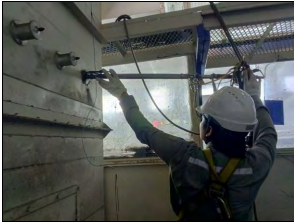
ภาพที่ 7 การเก็บตัวอย่างอากาศจากปล่องระบายอากาศ Exhaust Fan Primer No.3 (Plant C)
