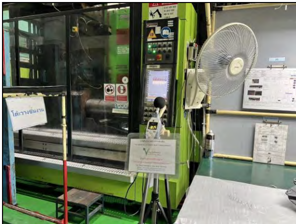
ภาพที่ 51 การตรวจวัดระดับความดังเสียงเฉลี่ย 8 ชั่วโมง บริเวณ อาคาร C (IF018)
