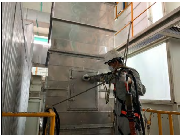
ภาพที่ 17 การเก็บตัวอย่างอากาศจากปล่องระบายอากาศ Exhaust Fan Base No.6 (Plant C)
