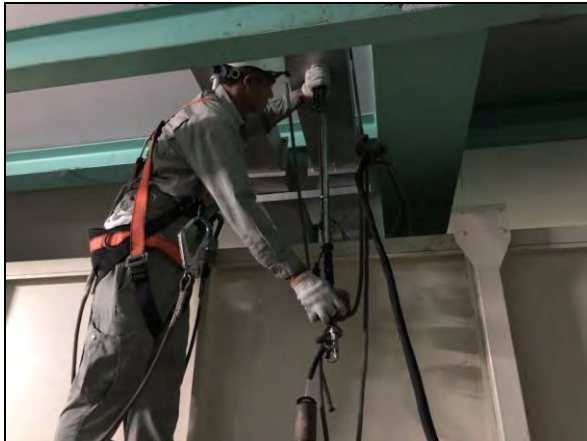
ภาพที่ 15 การเก็บตัวอย่างอากาศจากปล่องระบายอากาศ Exhaust Oven No.1 (Plant E)
